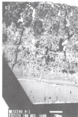
10. Plano estratigráfico de la Muestra 2: a) MO (500 x); b) MEB (electrones retrodispersados). c) Corte estratigráfico, imagen en MET (100 nm).
