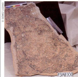
1. Fragmento de mosaico, previo a la intervención: Vista del reverso del tapiz teselar. El engasado del anverso.
