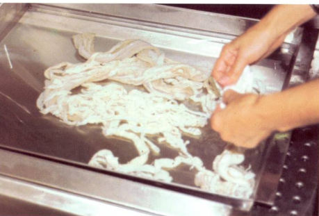
Lavado de tripas para su transformación en película y colágeno
