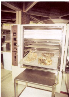
Cámara de humectación-deseccación.
